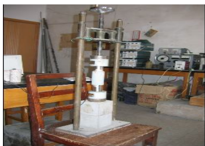
图 3 试验岩样横波测试图
