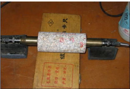
图 2 试验岩样纵波测试图 Fig.2 Rock mass specimen P-wave test
